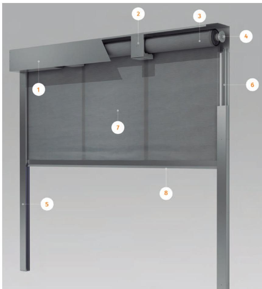
Le guide laterali di scorrimento sono opzionali e realizzate in acciaio zincato di 2,0 mm di spessore; hanno come dimensione standard 120 x 70 mm e, tramite un tubo posto all'interno a cui il tessuto è agganciato in tutta altezza, lo scorrimento del telo stesso risulta lineare assicurandone una adeguata tensione.
