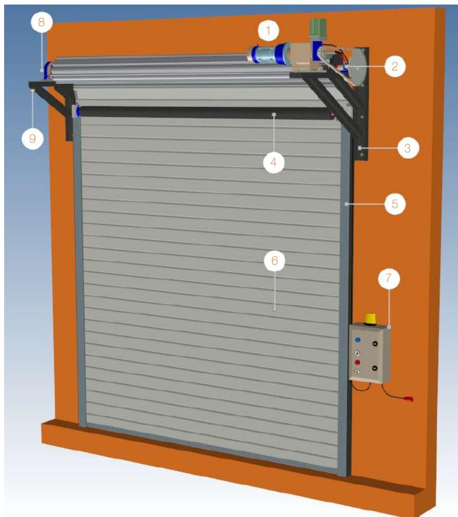
L'avvolgibile **BLOCKSHUTTER EI120** viene normalmente fornita con motore trifase 400V - IP54 con sistema detto Gravity fail safe, con rinvio a catena, e freno cinetico che fa in modo che la serranda scenda a velocità controllata, anche in caso di mancanza di corrente. Per il funzionamento in Gravity fail safe è obbligatorio installare un avvisatore acustico previsto dalla normativa EN 12604.
