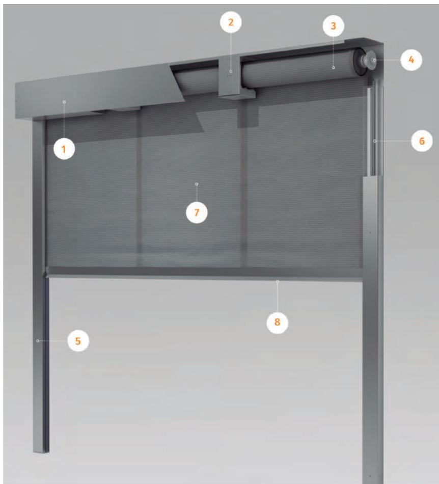
Le guide laterali per le tende **BLOCKCURTAIN E120 - EW60/90** sono realizzate in acciaio zincato di 2,0 mm di spessore, hanno come dimensione standard 120 x 70 mm e, tramite un tubo posto all'interno a cui il tessuto è agganciato in tutta altezza, lo scorrimento del telo stesso risulta lineare assicurandone una adeguata tensione.
