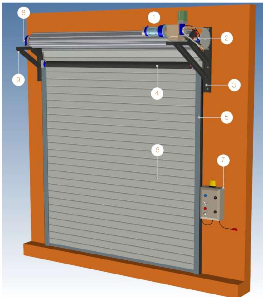
L' avvolgibile tagliafuoco **BLOCKSHUTTER EW120** viene normalmente fornita con motore trifase 400V - IP54 con sistema detto Gravity fail safe, con rinvio a catena, e freno cinetico che fa in modo che la serranda scenda a velocità controllata, anche in caso di mancanza di corrente.
